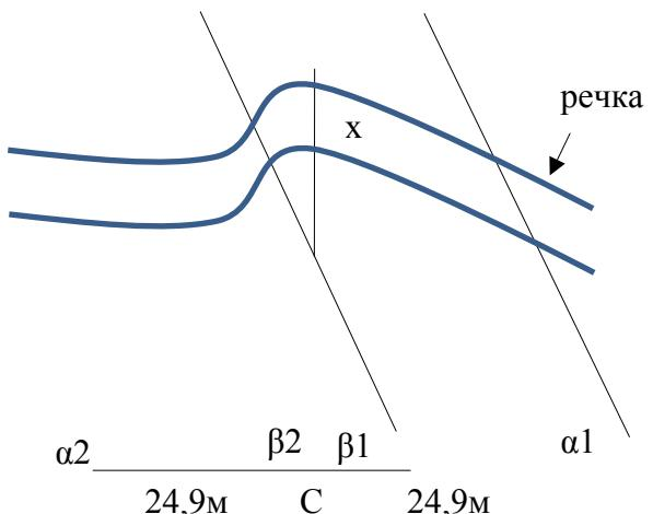
$$X_1 = 20,5 * \sin \alpha_1 / \sin \gamma_1 = 24,9 * \sin 84^\circ 10' / \sin 5^\circ 50' = 20,3 / 0,1 = 246,5 \text{ м}$$
